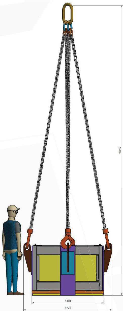
Rys. 4.12 Model kontenera górniczego szybowego
