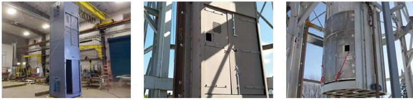
Rys. 4.10 Różne rodzaje klatek produkowane przez NMT, w tym prowadzone na linach (Kanada) [22]
