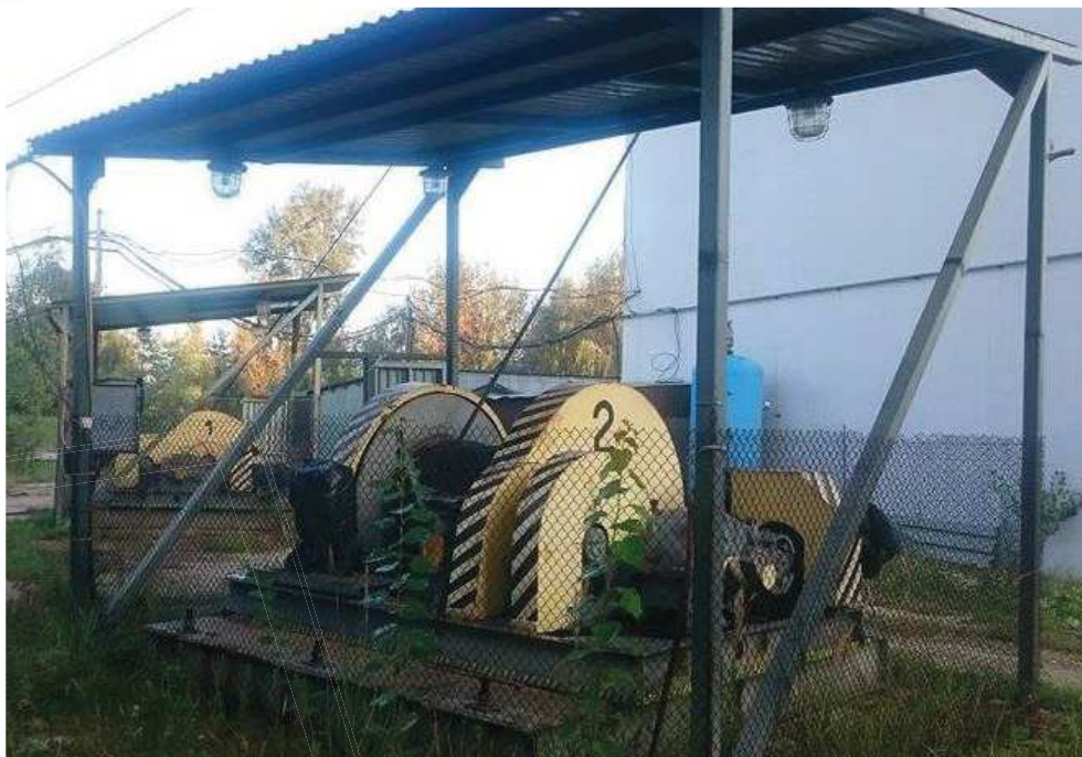
Rys. 3.5 Wciągarka wolnobieżna pomostu wiszącego, typ KUBA 10 [4]
